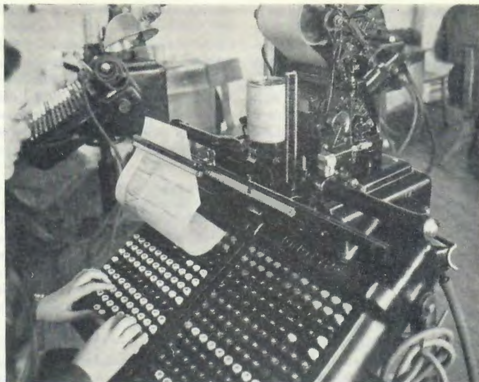
Fig. 15. Monotype-skrivbordet påminner om en vanlig skrivmaskin men är som synes betydligt större och har många fler tangenter.
