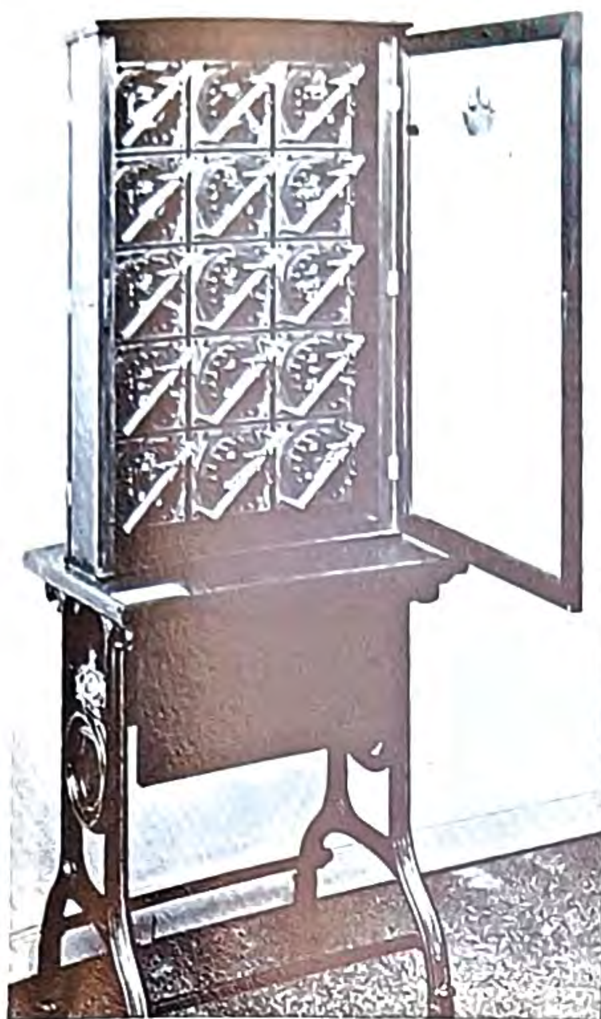
Automatisk telefonväxel för 15 linjer, system Pehrson-Betulander. Belönad med guldmedalj vid världsutställningen i Paris 1900.
